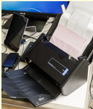
「ScanSnap iX500」でのスキャン。サイズや向きが異なる書類もまとめてセットできる。
